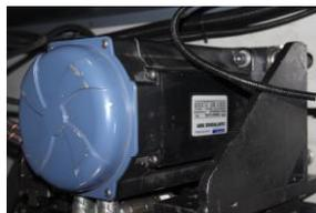
Der exklusive [Cartridge DDR® Motor](#) vereint die Leistungsvorteile gehäuseloser [Direktantriebsmotoren](#) mit der einfachen Montage von Gehäusemotoren. Er bietet eine einzigartige lagerlose Konstruktion und wird über ein werkseitig justiertes, hochauflösendes Rückführsystem direkt mit der Last gekoppelt. Der Rotor ruht dabei auf den Lagern der Maschine. Die meisten Modelle lassen sich innerhalb von fünf Minuten installieren.
